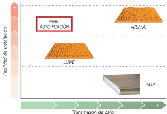
Cuadro sobre la eficiencia en transmisión térmica de los paneles de ORKLI.
