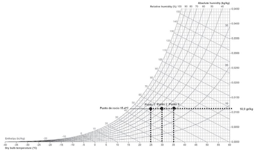
**Figura 6.6.** Representación de un sistema de control basado en la humedad absoluta
