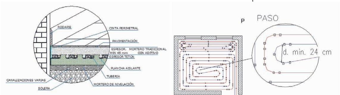
Figura 3.1a. Sección tipo de un suelo radiante
