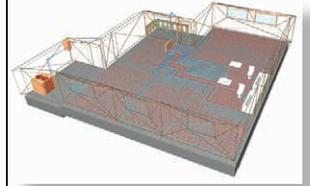
El principio básico del sistema de calefacción y refrigeración mediante superficies radiantes, consiste en la impulsión de agua a media temperatura (en torno a los 40°C en invierno y a los 16°C en verano) a través de circuitos de tuberías plásticas fabricadas principalmente en polietileno.
