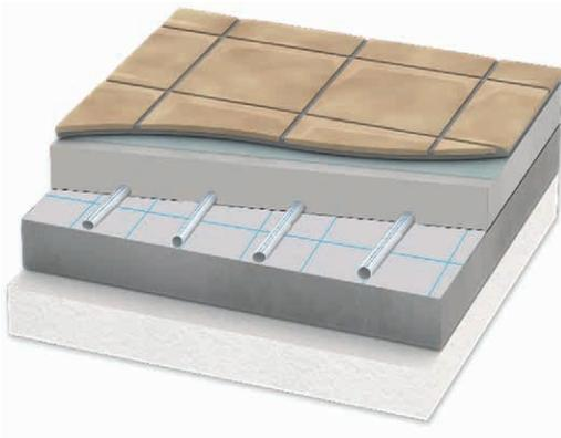
Estos circuitos se soportan sobre un aislante térmico y quedan recubiertos por una capa de mortero de cemento, que los recubre y sobre la que se coloca el pavimento final el cual podrá ser de tipo cerámico, piedra, madera, linóleo u otros.
