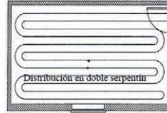
El tubo se fijará sobre el material aislante bien con la ayuda de los tetones moldeados o con grapas de fijación.
