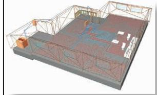
Para limitar el flujo de calor a través del suelo de las habitaciones situadas inmediatamente debajo, la resistencia térmica de la capa de aislamiento  $R_{\lambda, ins}$  debe de estar al menos de acuerdo con tabla:
