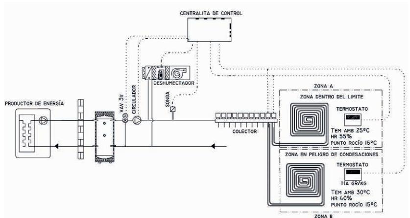
**Figura 6.7.** Representación de sistema de control por humedad absoluta con deshumectación, centralita de control y válvula de 3 vías controlada por la centralita en función del punto de rocío elaborado por cada termostato de control por humedad absoluta de cada zona.
