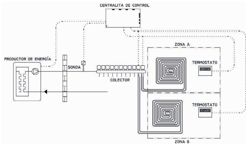
**Figura 6.1.** Representación de termostatos de zona actuando sobre los cabezales y enviando información a la central de control para gestión de la producción y temperatura de agua.
