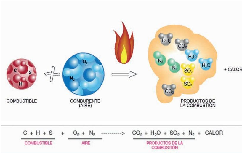
El vapor de agua del humo de las calderas determina en gran medida el posible funcionamiento de la caldera y más en concreto la temperatura de trabajo de la misma. Si la caldera trabaja a temperaturas bajas, el vapor de agua puede condensarse en forma de agua líquida y si la caldera no está preparada para esto puede sufrir graves averías.
