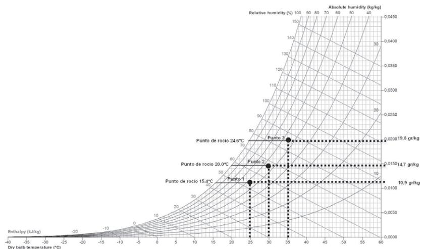
Figura 6.4. Representación de un sistema de control basado en la humedad relativa
