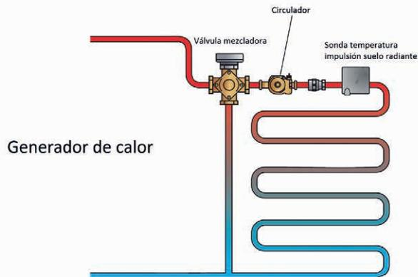
Si tenemos varios circuitos de calefacción, que pueden funcionar a diferentes temperaturas o con diferentes horarios, tendremos que repetir el circuito con válvula mezcladora en cada uno de ellos.
