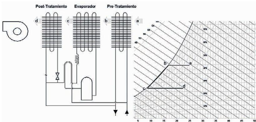
Figura 6.8. Esquemas del principio de funcionamiento de la deshumidificación isotérmica
